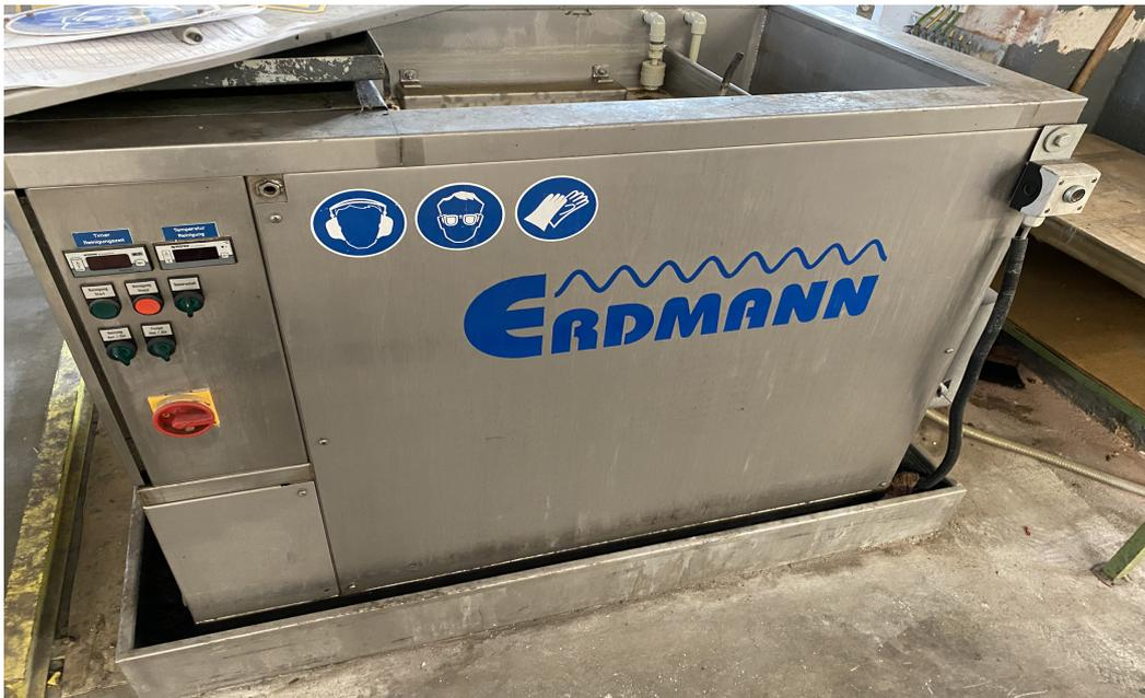
Ultraschallreinigungsanlage mit Oberflächenabschwemmung und Filtereinheit:
